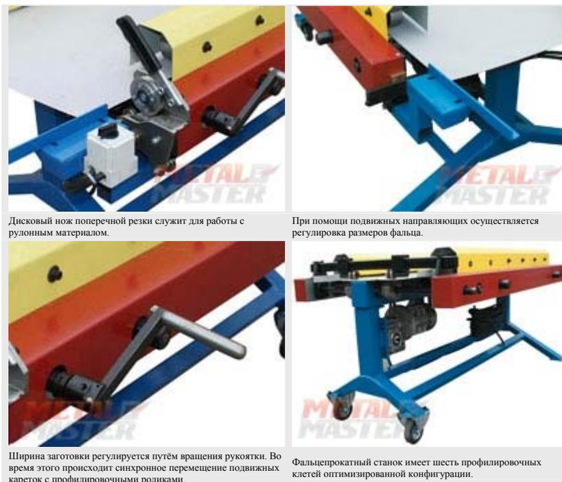
Дисковый нож поперечной резки служит для работы с рулонным материалом.
